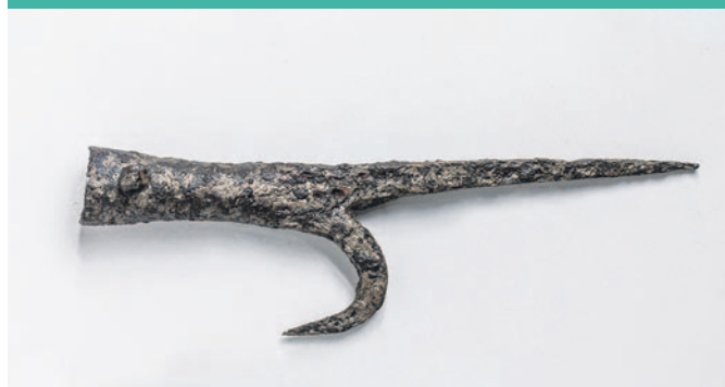
Flößerspieß, Universalwerkzeug: Die Spitze diente zum Wegstoßen, der Haken zum Heranholen der Flöße.
